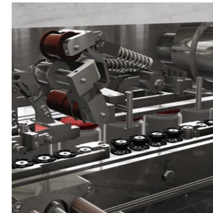
Verschlussübergabe, Andrücker und Verschlussriemen seit über fünf Jahrzehnten in bewährter Ausführung – komplett rostfrei.
